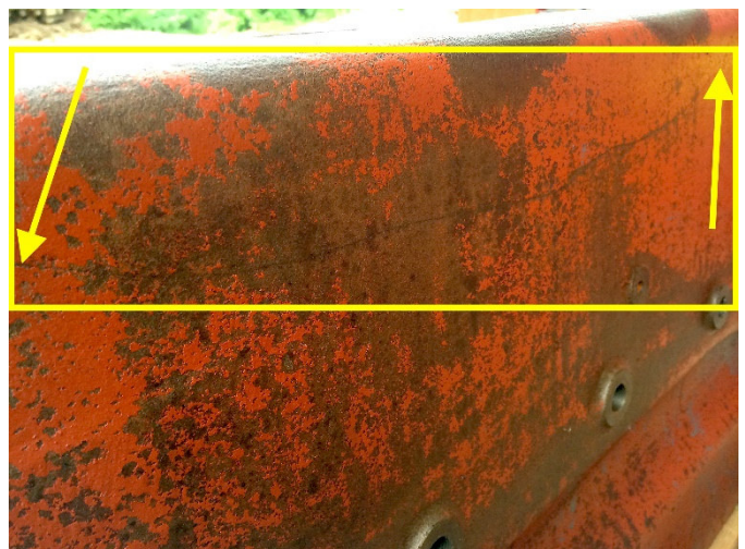
↓ Gleicher Sechsender: Wird der Motor mit Blockriss lange genug betrieben, reißt dieser auch auf der Lüfterwellenseite vollständig durch.
