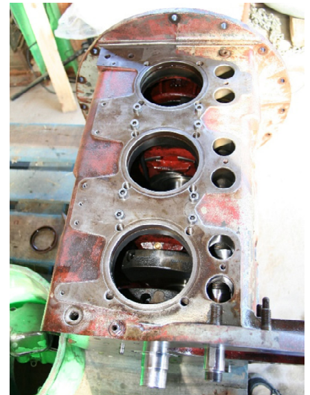
↑ Dreizylinder nach Scheuer gebohrt: Zwischen den Zylindern sind die Inbus-Köpfe der M8er Schrauben gut zu erkennen.
