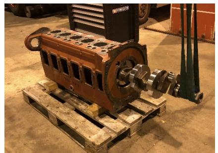
↑ Kurbelwellen-Einbau: Die neuen Lagerträger werden auch auf der Kurbelwelle verschraubt und anschließend mitsamt Welle von hinten in den Motorblock geführt.
