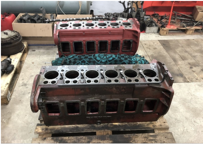
↑ Beide Bauarten betroffen: Sechszylinder-Gehäuse der alten und neuen Generation reißen - hier zwei nach Eicher/Braun bearbeitete Motoren.
