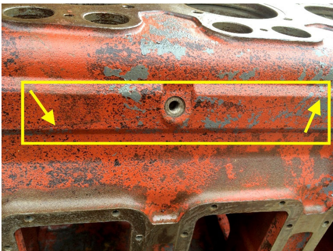
↓ Sechszylinder mit offener Wunde: Nachdem die Lagerstege abgerissen sind, gibt die Außenwand auf ganzer Länge nach (Anfang und Ende des Risses erstrecken sich über die Pfeilenden hinaus).
